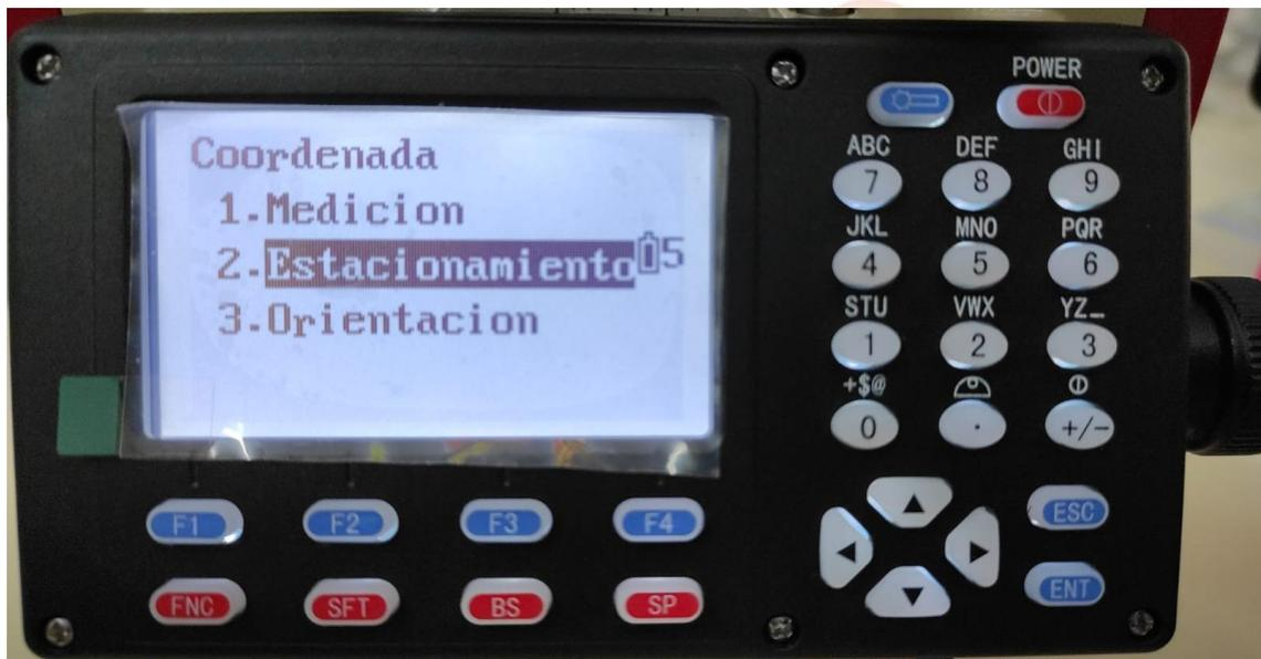
Pulsamos enter en “Estacionamiento” > Leer o F1 > Elegimos la coordenadas de la estación, enter > Agregamos altura de instrumento y altura del prima > OK
